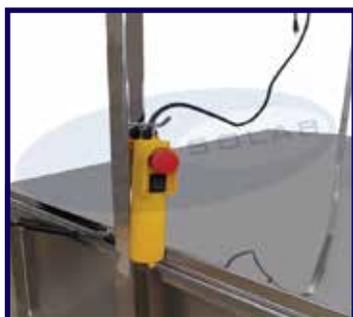
Sistema elétrico para subida e descida do berço
