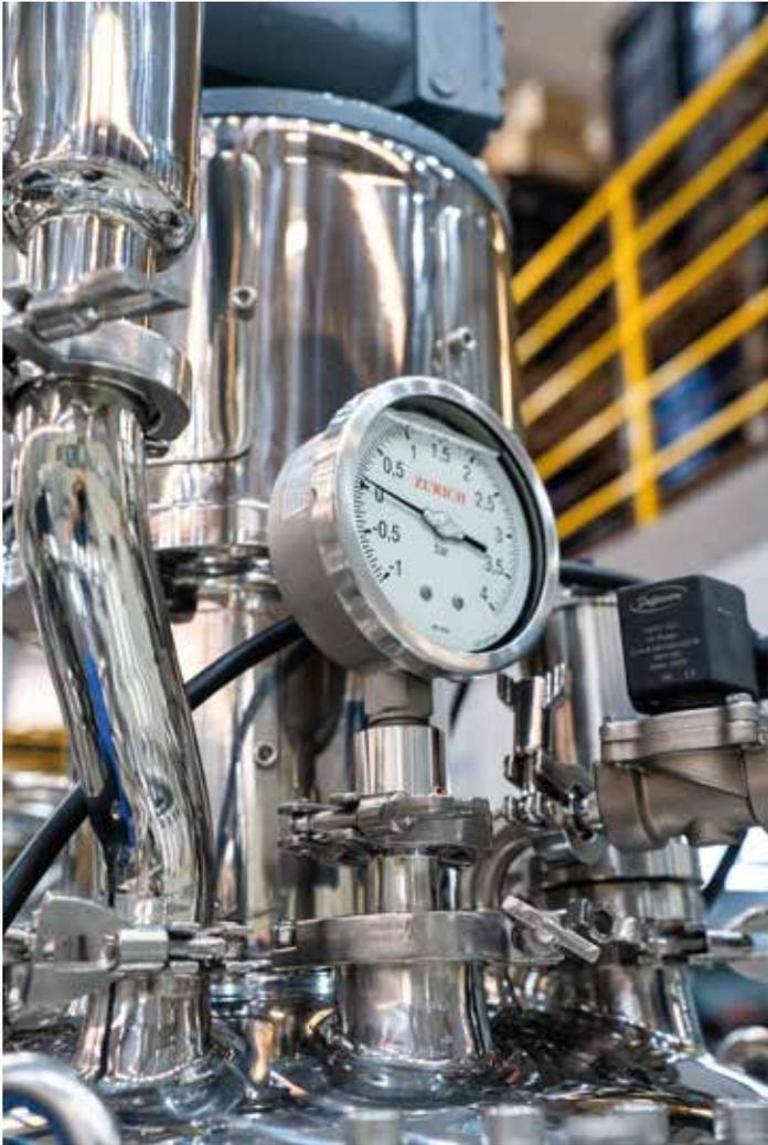
Mas este não é apenas um reator de fermentação: é uma plataforma automatizada de bioprocessos, capaz de atender desde fungos e bactérias até células de mamíferos e insetos. Essa versatilidade se apoia em um controle rigoroso de pH, oxigênio e temperatura, conduzido por um software CLP com lógica PID avançada, que ajusta automaticamente nutrientes, ácido, base e antiespumante.
